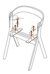
Avvitare le piastre alla struttura di legno con le viti M6x20 fornite. | Screw the two metal plates to the wooden structure with the supplied screws M6x20.
