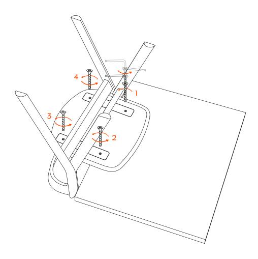
Avvitare le piastre alla seduta con le viti M6x16 in dotazione, seguendo l'ordine indicato da immagine. | Screw the seat to the metal plates with the supplied screws M6x16, following the illustrated order.
