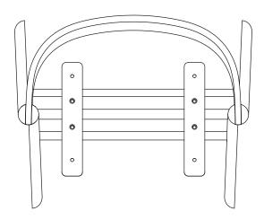
Posizionare le due piastre sopra la struttura di legno della sedia, con le svasature centrali verso l'alto, come da immagine. | Lay the metal plates on the upper part of the chair structure, with the central countersink facing upwards.
